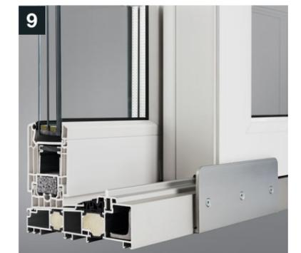
Der verschraubte Stahlwinkel an der Bodenschwelle bietet am Mittelstoß Schutz vor Einbruch mittels Kuhfuß.
